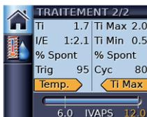
✓ Traitement avec indicateurs de respiration déclenchée par Trigger (Temp.) et de cyclage (Temp., Ti Max ou Ti Min) de l'appareil
